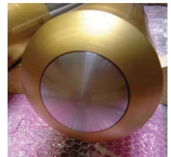
Hlava pístu s povlakem z karbidu wolframu
