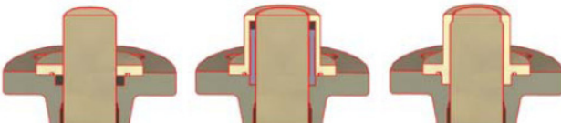
Model 28KV Radiální měkké těsnění v tělese ventilu
